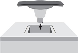
**1** Ablauftopf in Deckenaussparung (Aussparungsmaße siehe Seite 8) einsetzen und fest einbetonieren. Der Flansch soll möglichst oberflächenbündig und sauber in die Unterlage eingelassen werden.
