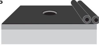
**5** Bitumenmasse von Anschlussmanschette und Dichtungsbahn durch Erhitzen verflüssigen (Warmgasschweißverfahren). Obere Dichtungsbahn im verflüssigten Bitumen ausrollen und gleichmäßig fest andrücken bzw. anrollen (siehe Punkt 3).
