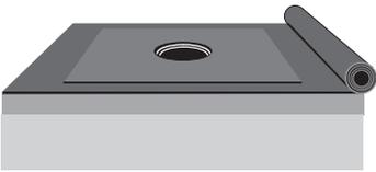
**3** Schutzfolie entfernen und Anschlussmanschette über der gelochten Dichtungsbahn entfalten.
